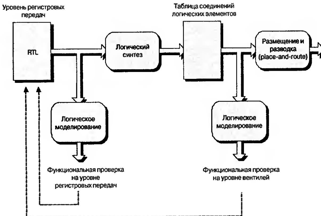
Рис. 9.2. Цикл HDL-проектирования заказных микросхем (простой)
